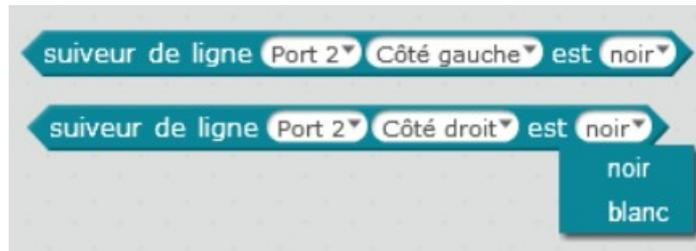
Scratch met à disposition du programmeur une instruction qui permet de lire la valeur des deux capteurs en même temps.
