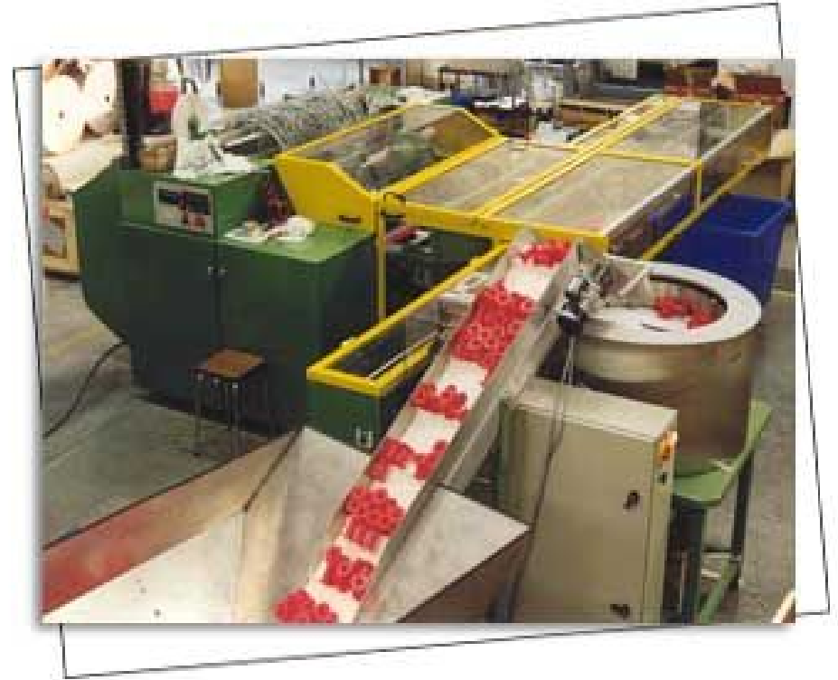
Machine à enrouler le sparadrap sur des rouleaux
