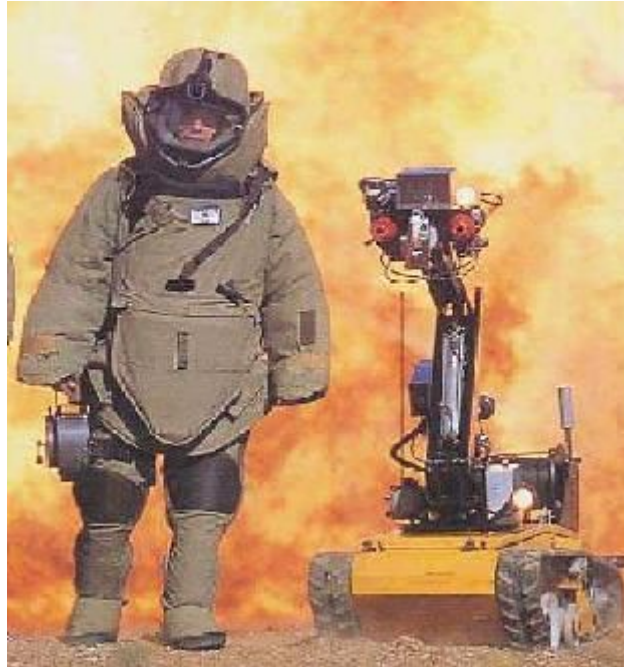
Les robots démineurs : L'engin chenille visible à côté du démineur est un robot (ou télémanipulateur) équipé d'un bras portant une caméra, une pince, et deux canons à eau.
