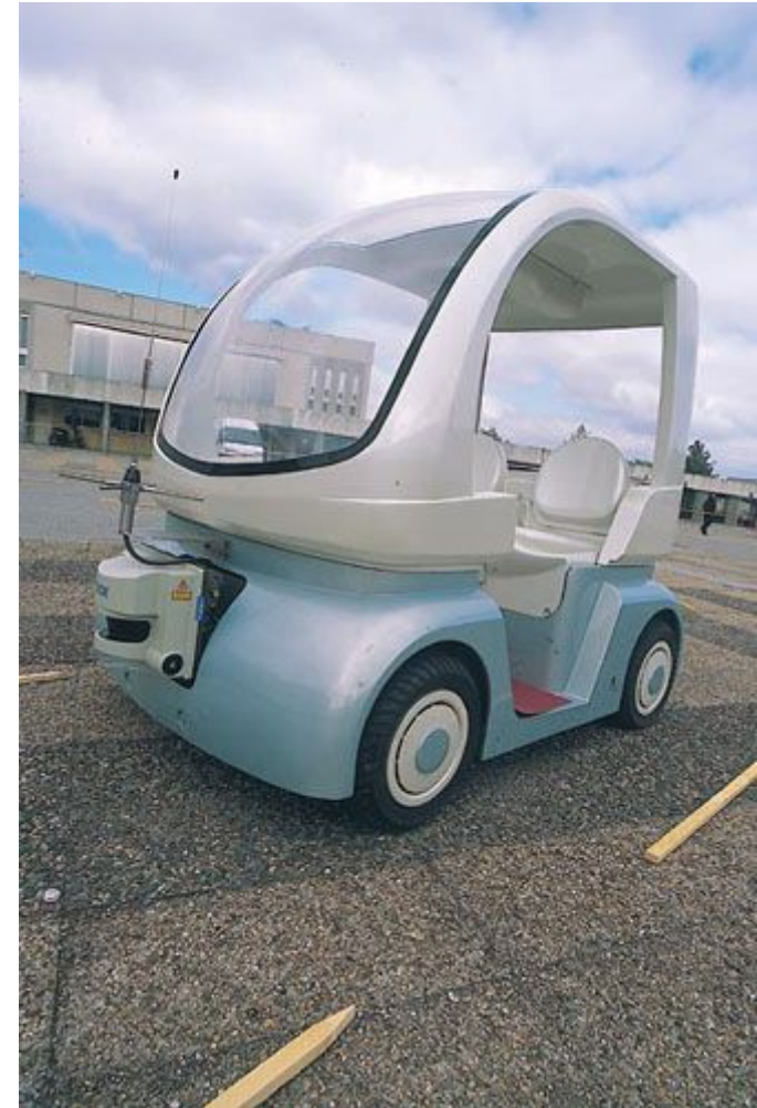
Le CyCab, véhicule électrique urbain, est guidé automatiquement par GPS
