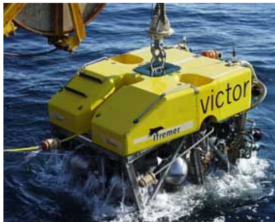
Robot sous-marin : Ce type de robot permet l'inspection des coques de pétrolier (ex l'Erika) au fond des océans
