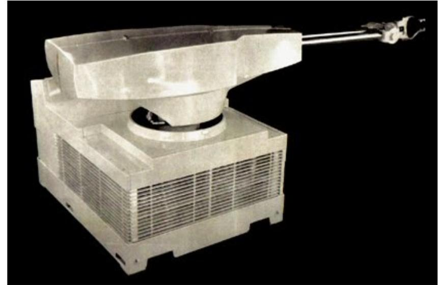
1960 : Le premier robot industriel appelé Unimate, était capable de manipuler des objets avec des actionneurs hydrauliques.
